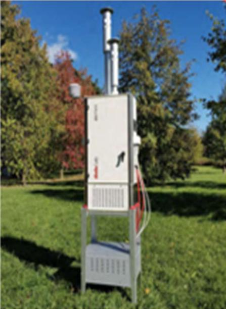
**Figura 1: Sistema di campionamento per le polveri sottili**
